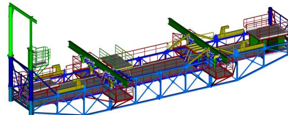
SPRETEC a conçu, dimensionné et étudié les plateformes automotrices de maintenance du pont de Rion-Antirion (équipements permanents parasismiques) circulant sous le tablier du pont et servant aux opérations de maintenance.
