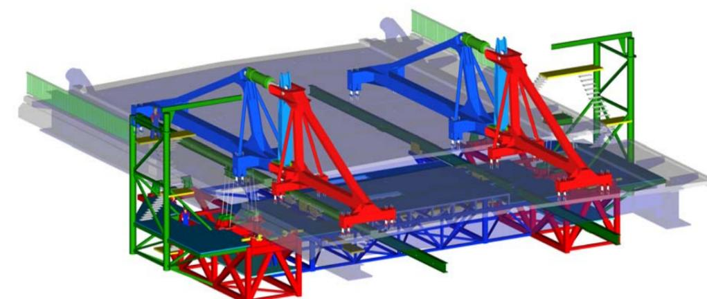
SPRETEC a conçu, dimensionné et étudié les outillages temporaires (Quick Connection Device et Marsupial Platform) servant à l'accostage et au réglage, avant éclissage, des voussoirs formant le tablier du pont de Rion-Antirion (Grèce) ; Les voussoirs sont levés avec une grue flottante..
