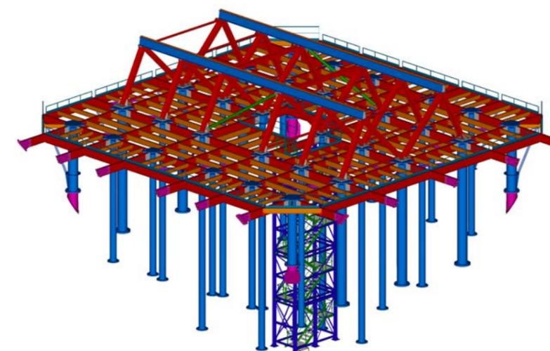
SPRETEC a conçu, dimensionné et étudié les plateformes de travail (équipements permanents parasismiques) servant au montage des voussoirs et situées dans les pylônes en béton du pont de Rion-Antirion.
