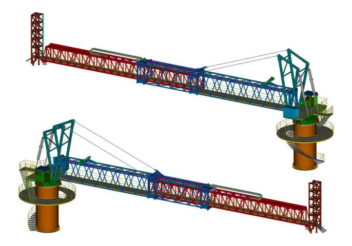
Dans le cadre du projet ROSA-LIRIO pour TOTAL, SPRETEC a conçu, étudié et dimensionné, une passerelle d'accès entre une base de vie et un puit de forage (ouvrage maritime).
