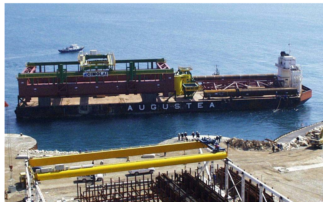
CATAMARAN XY SUR BARGE DE TRANSPORT
