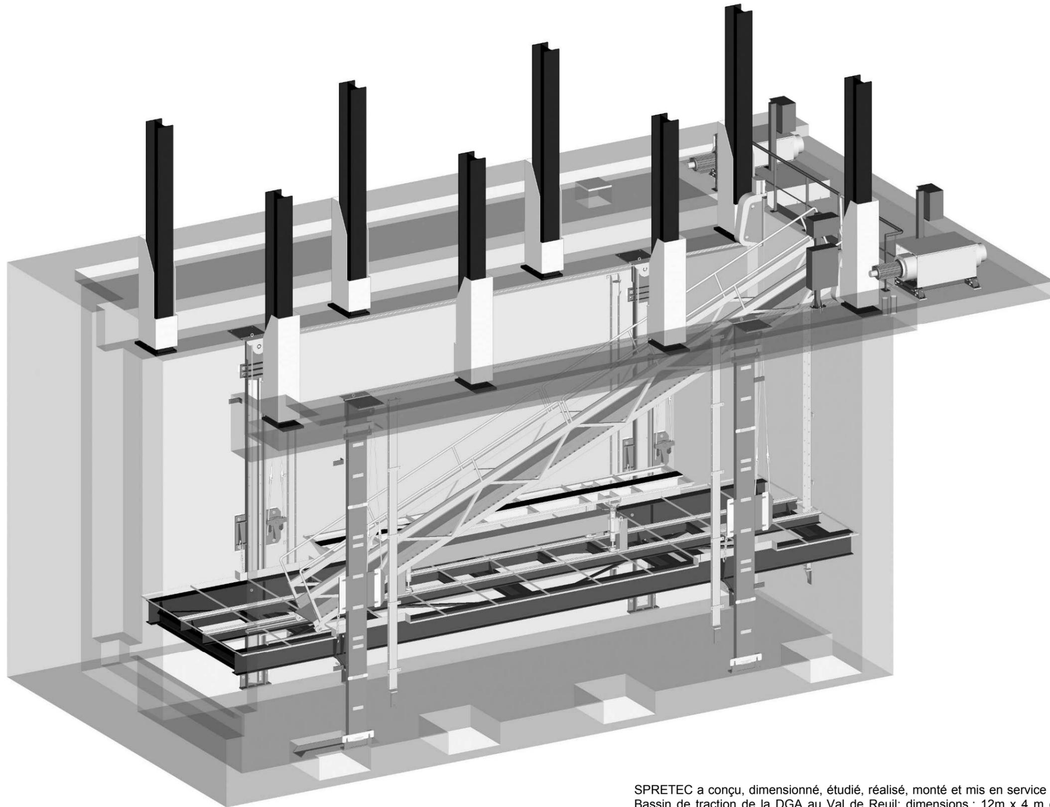
SPRETEC a conçu, dimensionné, étudié, réalisé, monté et mis en service les plateaux élévateurs du Bassin de traction de la DGA au Val de Reuil; dimensions : 12m x 4 m et 15m x 4m, capacité de levage = 6 tonnes.
