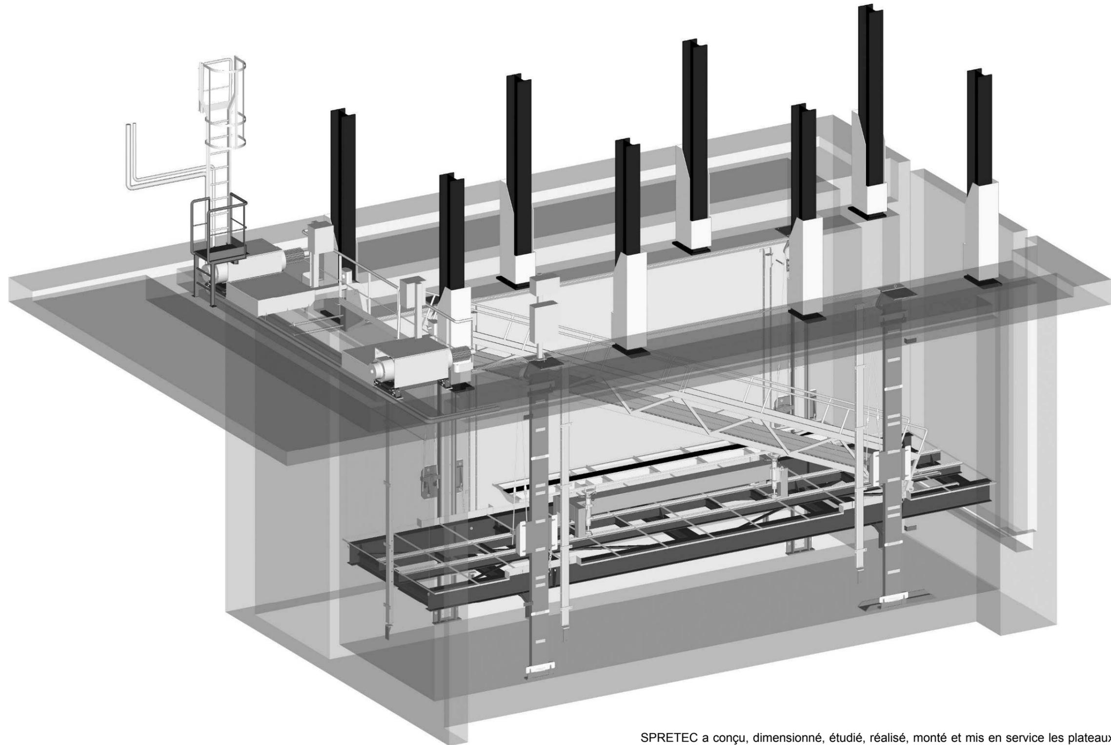
SPRETEC a conçu, dimensionné, étudié, réalisé, monté et mis en service les plateaux élévateurs du Bassin de traction de la DGA au Val de Reuil; dimensions : 12m x 4 m et 15m x 4m, capacité de levage = 6 tonnes.
