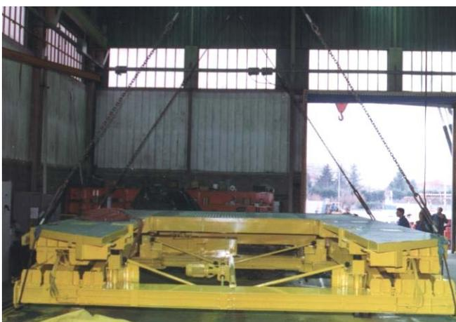
**SPRETEC** a conçu, dimensionné et étudié une table élévatrice d'une capacité de 6 To avec 5 m de course pour le positionnement du moteur VULCAIN sur le banc d'essai de SEP SNECMA.
