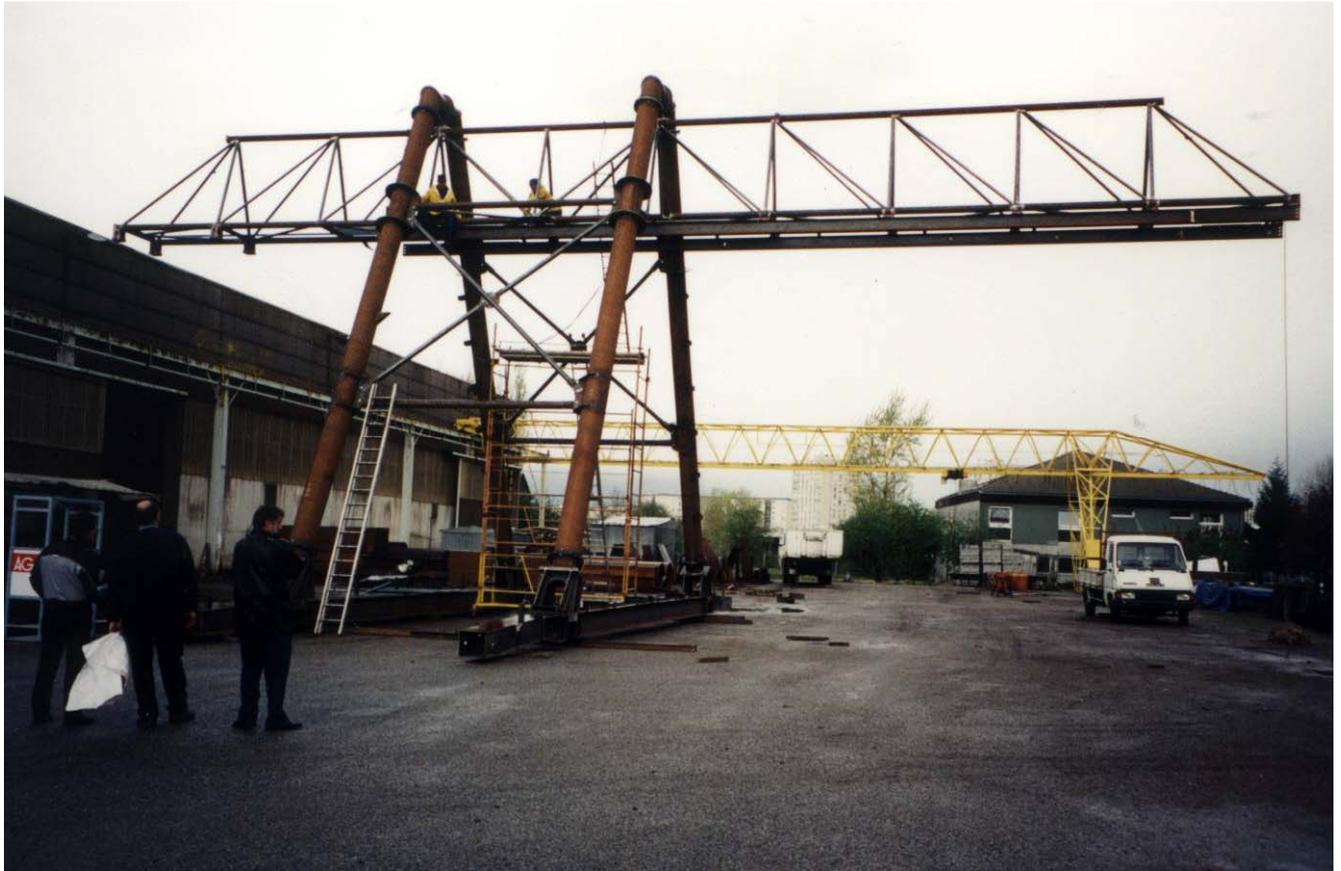
**SPRETEC** a conçu, dimensionné et étudié deux grues marteaux mobiles, de capacité 10 To à 10 m, implantés sur les barrages de ROCHEMAURE et PIERRE-BENITE sur le RHONE ; ces moyens de manutention assurent le démontage et le remontage des boggies des vannes wagon du barrage pour la maintenance.
